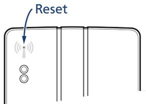
Um den Werksreset durchzuführen, nehmen Sie einen ca. 1mm dünnen Gegenstand zur Hand, wie beispielsweise eine Büroklammer. Auf der Gehäusevorderseite Ihres **SmartConnect easy** befindet sich ein Antennen-Symbol. In der Mitte dieses Symbols ist eine kleine Öffnung, hinter der sich die Reset-Taste befindet. Das Leuchten der beiden LEDs drückt den Reset-Zustand aus (siehe Tabelle unten).
