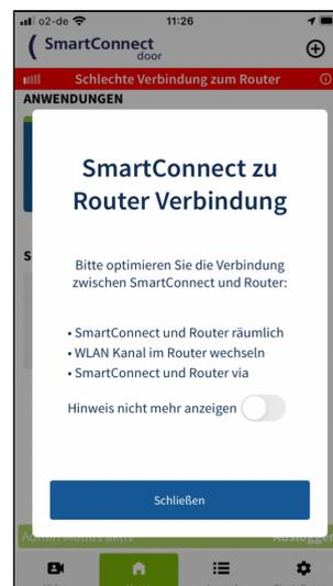
3 Durch Aktivieren des Schalters **Hinweis nicht mehr anzeigen** innerhalb des Pop-ups kann die **Verbindungswarnung** dauerhaft **ausgeblendet** werden.
