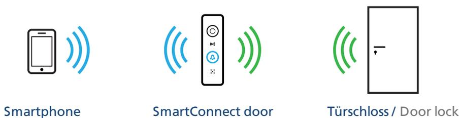
Achten Sie unbedingt auf eine **sehr gute WLAN Verbindung zum SmartConnect door**. Der WLAN Zugangspunkt (Router/Repeater) sollte **nicht mehr als 2 Meter** vom SmartConnect entfernt sein, um eine zuverlässige Datenübertragung zu gewährleisten. Nutzen Sie hierzu auch die Möglichkeiten des Kapitels "Verbindungsqualität" weiter unten.
