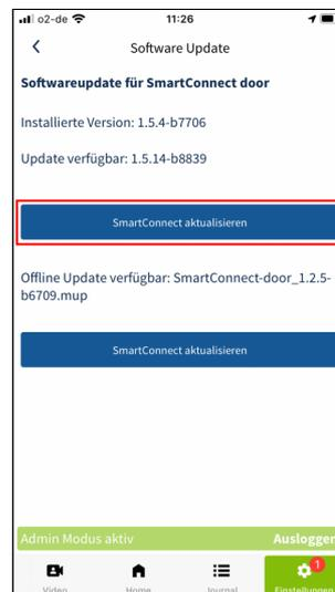
5 Das **SmartConnect** installiert nun das Update. Dieser Vorgang kann einige Minuten dauern und wird Ihnen durch blinkende LEDs angezeigt. Warten Sie bis das Update abgeschlossen ist.
