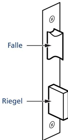
Ist die **Tagesfallen-Funktion** aktiv, sichert das Motorschloss die Tür nur über die **Falle**. Ideal für stark frequentierte Türen, bei denen dennoch ein kontrollierter Zutritt erfolgen soll.
