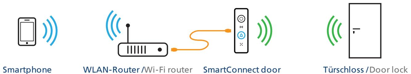
**Access-Point-Modus:** Direkte WLAN Verbindung zum **SmartConnect** (Auslieferungszustand). Dieser Weg sollte nur verwendet werden, wenn kein Heimnetzwerk verfügbar ist, da zum Bedienen des **SmartConnects** immer in das WLAN des **SmartConnects** gewechselt werden muss und somit kein Internet zur Verfügung steht.
